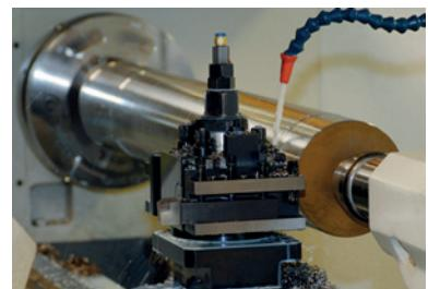
« 810 LICOOP » convient essentiellement aux opérations nécessitant un refroidissement intense ou la surveillance du travail au travers d'un fluide parfaitement transparent.
